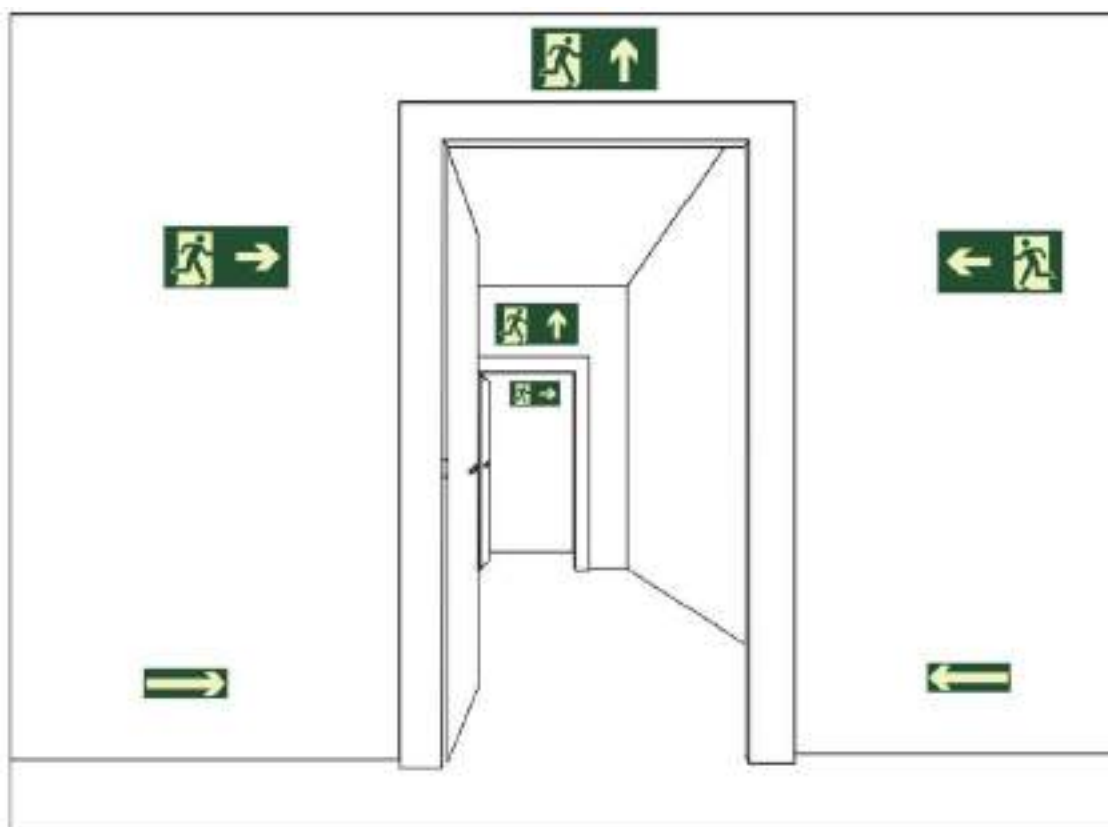
Figura C-11 - Sinalização de saída sobre paredes e vergas de portas.
