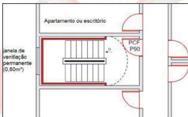
Figura 7 - Escada enclausurada protegida
