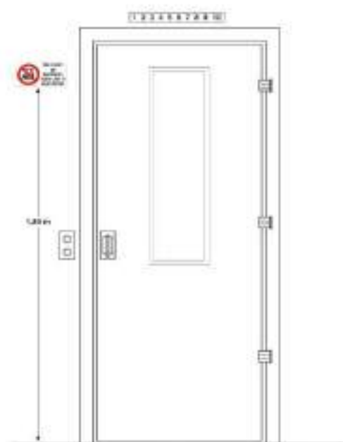
Figura C-4 - Sinalização de elevador (vista da escada).
