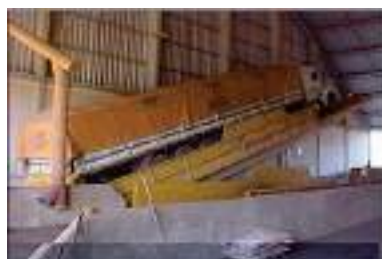
Figura 1: Elevador Agrícola (Tombador)
